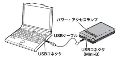
本製品が正常に動作しているか確認します。 以下の手順で、本製品が正常に動作しているか確認してください。
