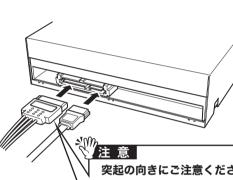
※シリアルATAケーブルとシリア ル電源ケーブルは、パソコンに付 属のケーブルをお使いいただく か、別途ご用意ください。本製品 にケーブルは付属していません。 ※シリアルATAケーブルを折り曲 げないでください。折り曲げる と、ケーブル内部で断線する恐 れがあります。
