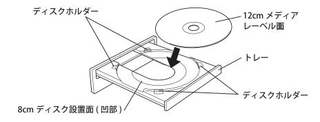
縦向きに設置した場合、図のように、下側にあるディスクホルダー 2箇所の間にメディアをセットします。
