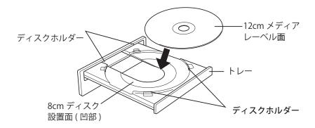
縦向きに設置した場合、図のように、下側にあるディスクホルダー 2箇所の間にメディアをセットします。
