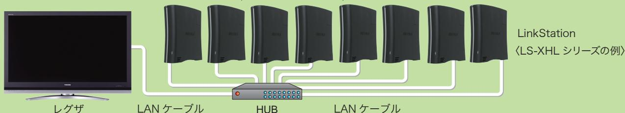
④レグザの電源スイッチを ON にし、LinkStation の電源スイッチを 1 台ずつ ON にします。
