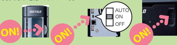
電源スイッチが「OFF」「ON」「AUTO」の選択ができる LinkStation では、「ON」にしてお使いください。PC連動電源スイッチのある LinkStation では、「MANUAL」にしてお使いください。「AUTO」では使用できません。
