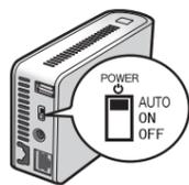
**AUTO:** NAS Navigator2がインストールされたパソコンが全て電源OFFになると自動的にLinkStationの電源がOFFになります(パソコンの状態を監視する微弱な電力は消費しています)。ネットワークでLinkStationに接続されたパソコンが1台でも電源スイッチがONになると、自動的にLinkStationの電源がONになります。
