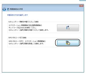
**6** 画面に PIN コードが表示されますので、PIN コードを控えて[次へ]をクリックします。
