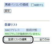
★線で接続できる機器と、接続できない機器を指定します。「検出された無線パソコン一覧」には、現在接続されている無線機器の MAC アドレスが表示されています。ここで、接続可能にする機器の MAC アドレスのみを[登録]をクリックして登録します。
