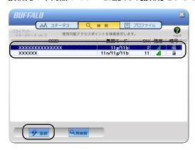
■メモ 本商品の SSID が表示されない場合は、 [再検索] をクリックしてください。それでも本商品の SSID が表示されない場合は、パソコンを本商品に近づけてください。また、本商品に ANY 接続拒否設定 (P92) を行っている場合は、解除してください。
