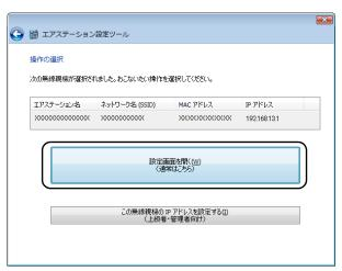
本商品とパソコンの IP セグメントが異なる場合は、以下の画面が表示されます。その場合は、[このパソコンのIPアドレスを設定する]→[推奨設定(DHCPサーバーから IP アドレスを自動取得する)]の順にクリックしてください。しばらくすると、パソコンに新しい IP アドレスが設定され、手順6へ進みます。
