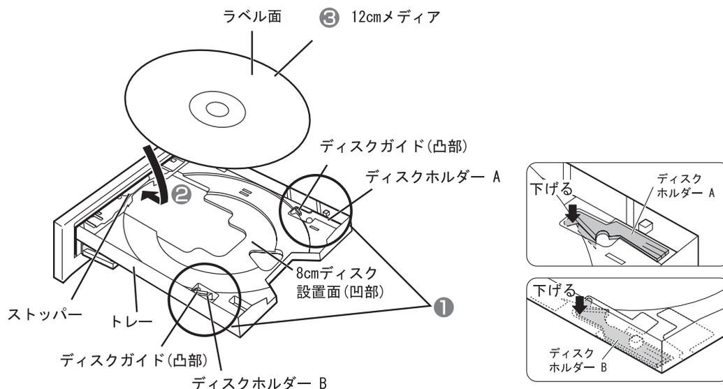
ディスクホルダーA,Bをトレー面と同じ高さになるように下げる。
