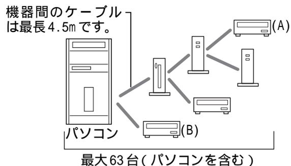
終端から終端の機器の間に使用できるケーブル数は最大16本(16ホップ)です。左図の例での終端は(A)と(B)となり、その間のケーブル数は ~ の4本(4ホップ)となります。
