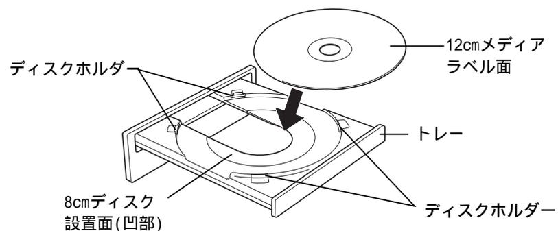
縦向きに設置した場合、図のように、下側にあるディスクホルダー
