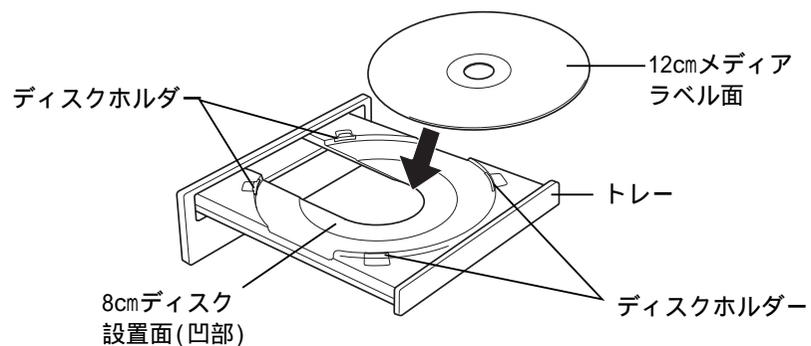
縦向きに設置した場合、図のように、下側にあるディスクホルダー2箇所の間にメディアをセットします。
