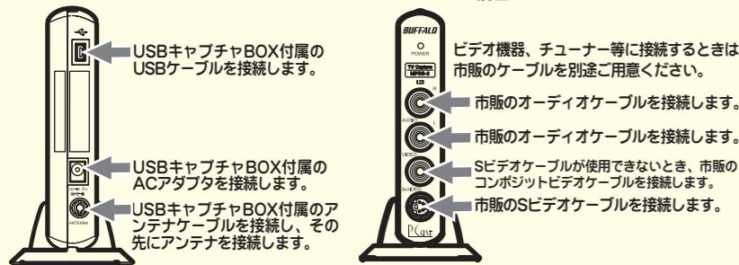
2 LinkStationのUSBコネクタにUSBキャプチャBOXを接続します。
