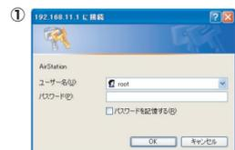
ユーザー名とパスワードの入力画面が表示されますので、「ユーザー名」欄→root(小文字) 「パスワード」欄→空欄として、[OK]をクリックします。
