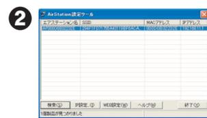
自動的にAirStation(親機)が検索されますので、検索されたAirStation(親機)を選択して、[WEB設定]をクリックします。
